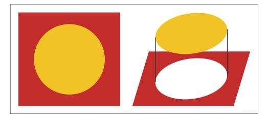
**Abb. 2** Bei Passungenauigkeiten entstehen schnell Blitzer an den Kanten des oberen Objekts (links). Durch eine Überfüllung (rechts) lässt sich das Problem vermeiden.
