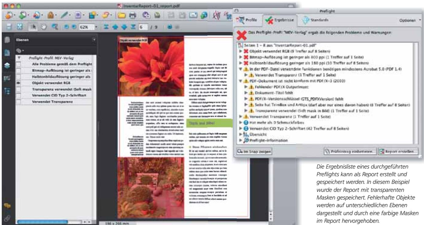
Die Ergebnisliste eines durchgeführten Preflights kann als Report erstellt und gespeichert werden. In diesem Beispiel wurde der Report mit transparenten Masken gespeichert. Fehlerhafte Objekte werden auf unterschiedlichen Ebenen dargestellt und durch eine farbige Masken im Report hervorgehoben.
