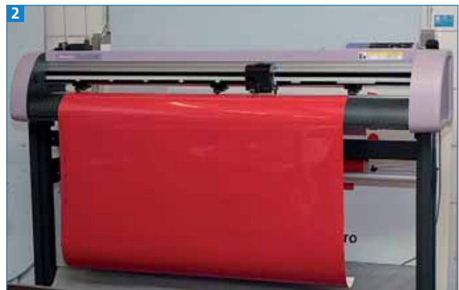
Folienplotter mit einer Folienbreite bis zu 1.300 mm
