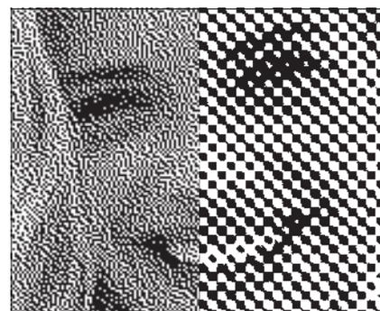
**2** Die zwei Arten der Rasterung: frequenzmoduliert (links: konstante Punktgröße, variable Abstände) und amplitudenmoduliert bzw. autotypisch (rechts: variable Punktgröße, konstante Abstände)
