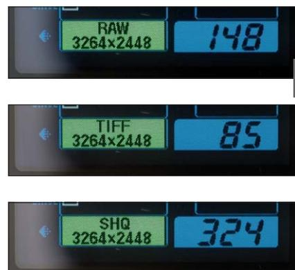
**1-3** Den Zusammenhang zwischen Dateiformat und (voraussichtlicher) Anzahl verfügbarer Aufnahmen auf einer 2-GB-CF-Card bei 8 MP Sensorgröße zeigen diese Aufnahmen eines Kamera-Displays. Die meisten Aufnahmen hat man bei SHQ (dem qualitativ besten JPEG-komprimierten Dateiformat der Kamera), die wenigsten bei TIFF. Raw ist ideal, zumal es die mit Abstand beste Qualität und mehr Fotos als TIFF liefert.
